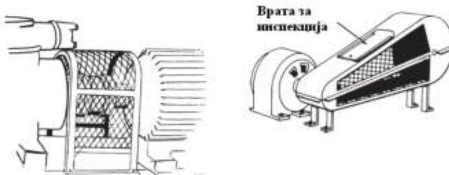
Слика 4.1а. Пример за механичка заштита на спојка и ременест пренос
